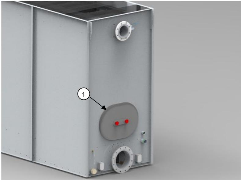
Abb. 76 Wartungsöffnung (Abbildung kann optionale Komponenten enthalten)
